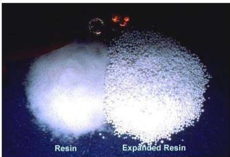
شکل (۴) تفاوت اندازه های رزین و دانه های منبسط شده (Prepuff)
