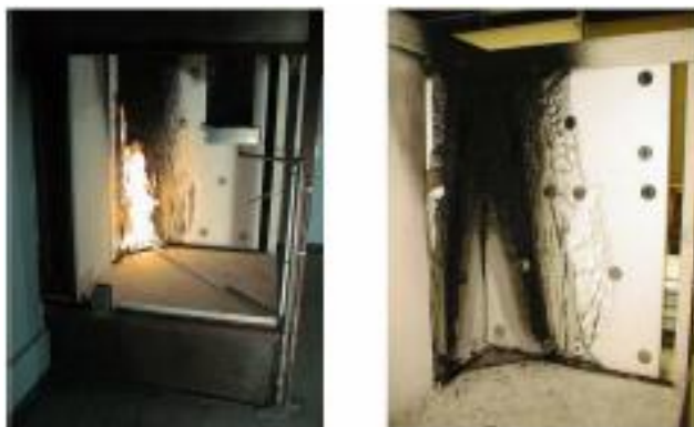
شکل (۱) چگونگی عملکرد این فوم در برابر آتش را نشان می دهد
